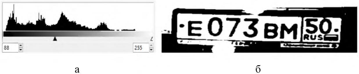
Рис. 5 – Применение порогового фильтра с порогом бинаризации, равным 88: а) гистограмма яркости; б) результат применения порогового фильтра
