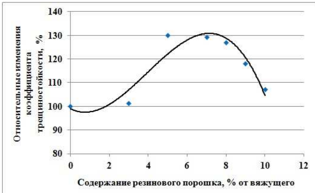
Рис. 3. График зависимости относительных изменений трещиностойкости закладочного массива от содержания резинового порошка
