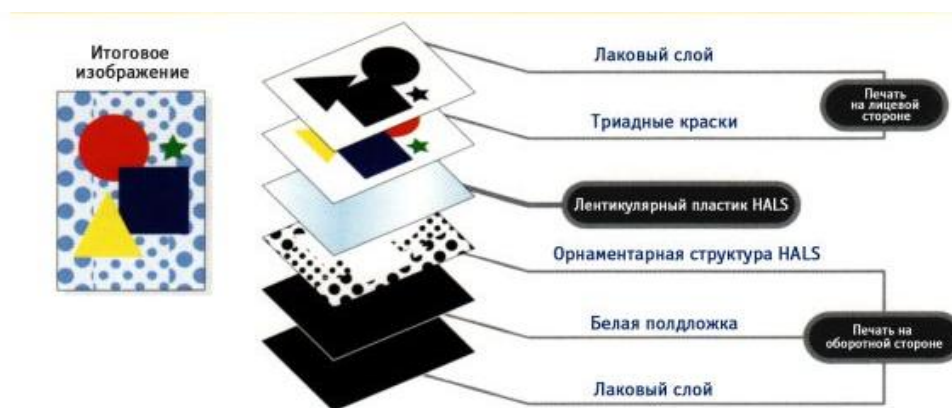
Рис.14. Схема запечатки лентикюляра.
