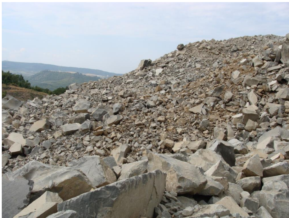
Рис. 2. Развал взорванной горной массы с фрагментами отказа
