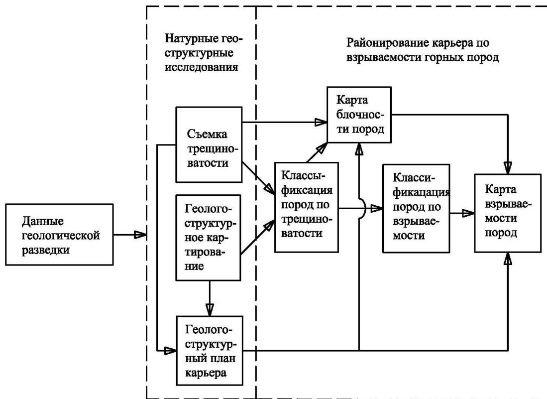
Рис. 1. Районирование карьера по взрываемости и блочности массивов горных пород
