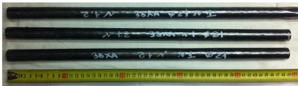
Рис. 2.1 Общий вид заготовок из стали 38ХА после теплой ротационной ковки по режиму №2
