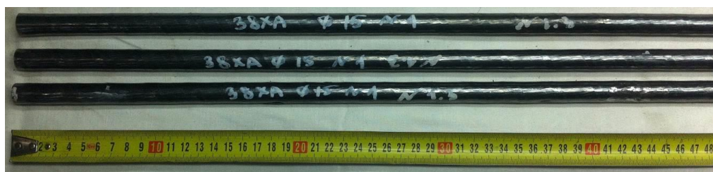
Рис. 2.2 Общий вид заготовок из стали 38ХА после теплой ротационной ковки по режиму №3
