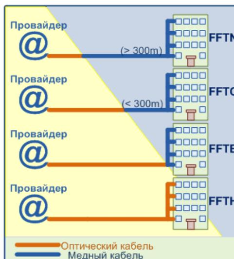
**Рисунок 2.1 – иллюстрация различных конфигураций семейства технологий FTТх.**
