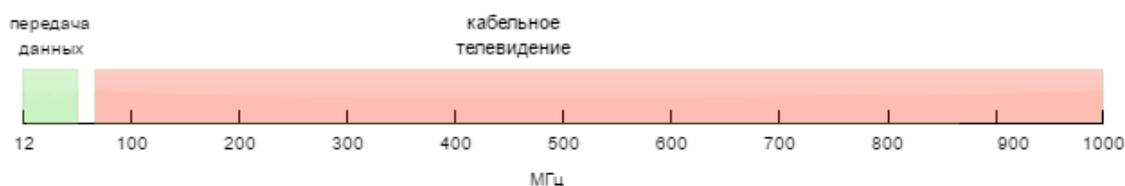
**Рисунок 2.3 – Иллюстрация использования частотного диапазона ЕоС**
