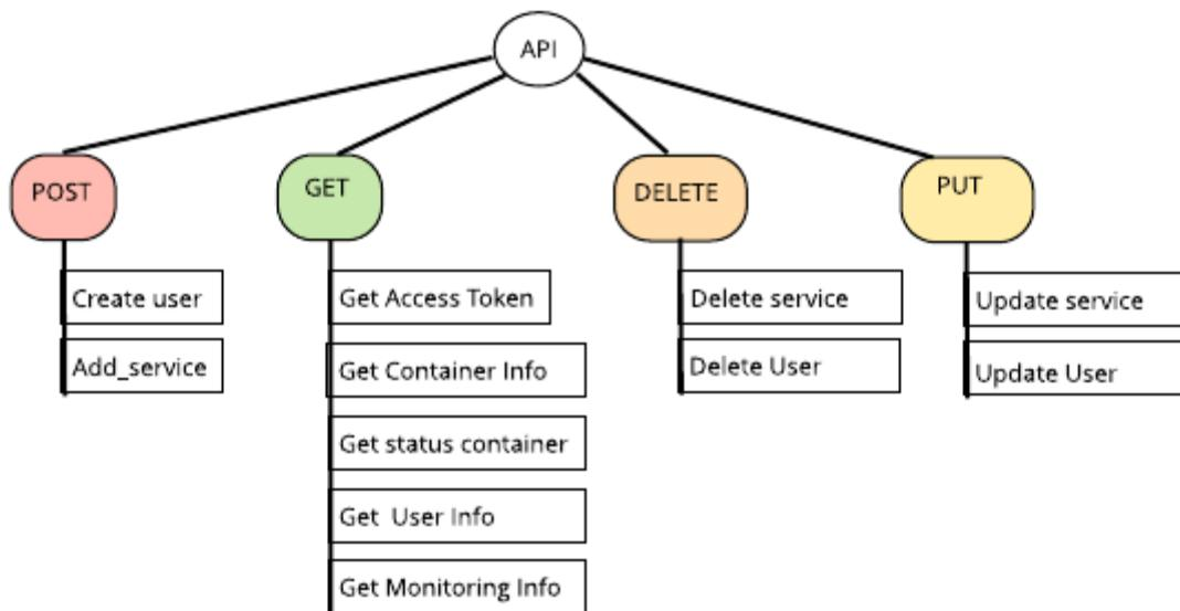
Рис. 2.5. Схема CRUD запросов API
