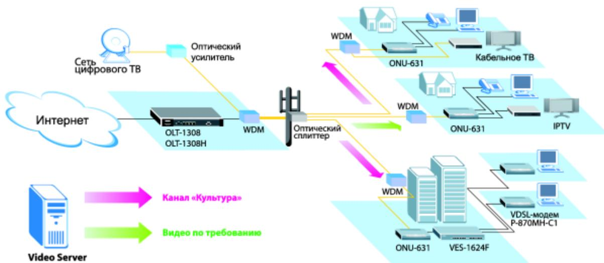
Рисунок 2.2 – Пример построения сети на базе PON
