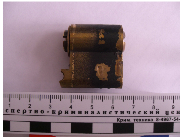
Рис. 1.5. Поверхностный след, образованный красящим веществом орудия взлома.
