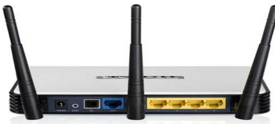
Рис.1.4. Модем-роутер TP-LINK TL-WR1043ND
