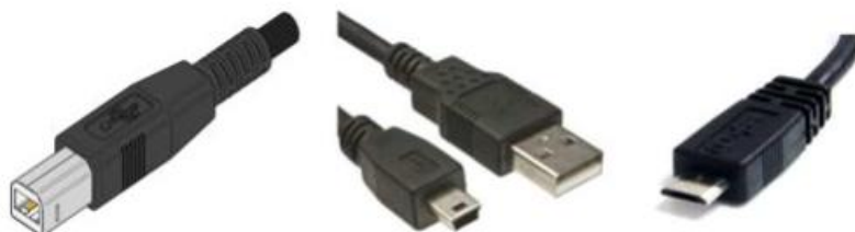
Рисунок 5 - Варианты кабелей для подключения платы к компьютеру
