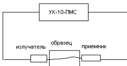
Рис. 2. Схема определения скорости распространения продольных волн
