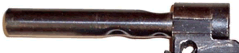
Рис 2.2 Вдавленности на стволе пистолета ИЖ79-9ТМ
