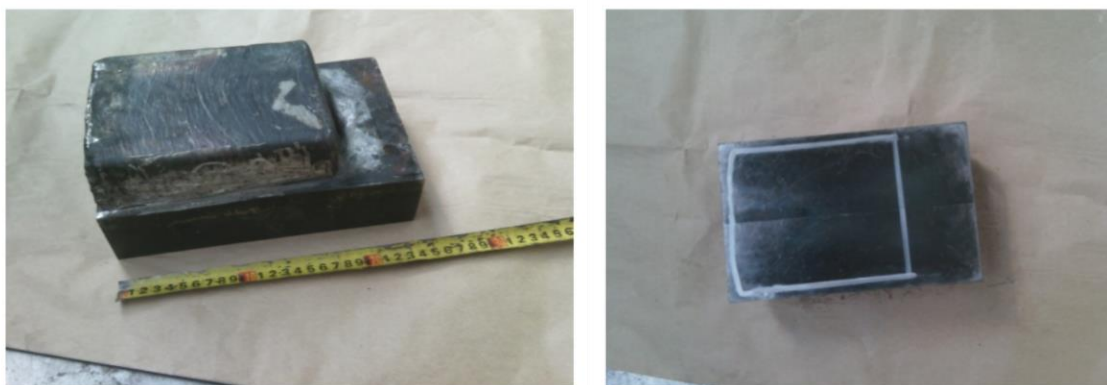
Рис. 2.1 Внешний вид биметаллической заготовки, изготовленной методом электрошлаковой наплавки стали 316L на заготовку из конструкционной стали марки S700MC (а), с обратной стороны основной заготовки отмечена зона сплавления слоев, исследованная методом ультразвуковой диагностики (б)
