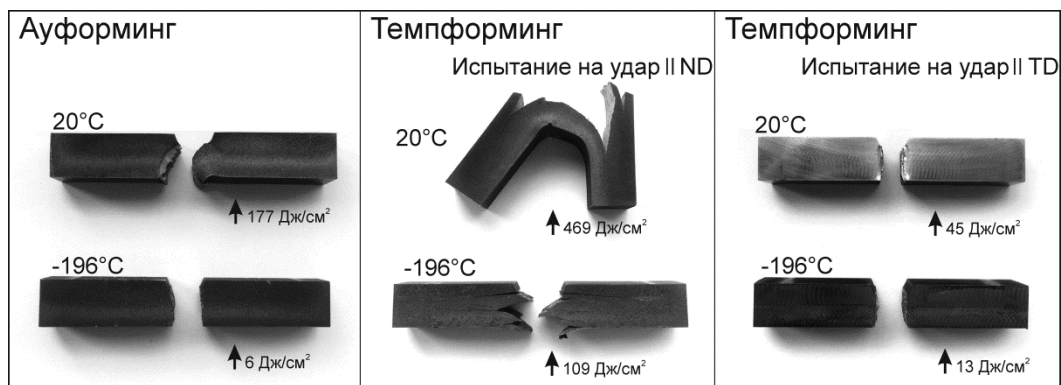
Рис. 3.8 Образцы стали типа S700MC, подвергнутые аусформингу и темпформингу. Стрелками показано направление удара
