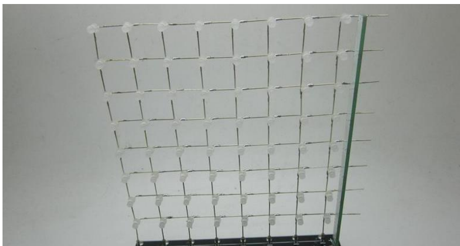
Рисунок 2.16 – Схема соединения светодиодов
