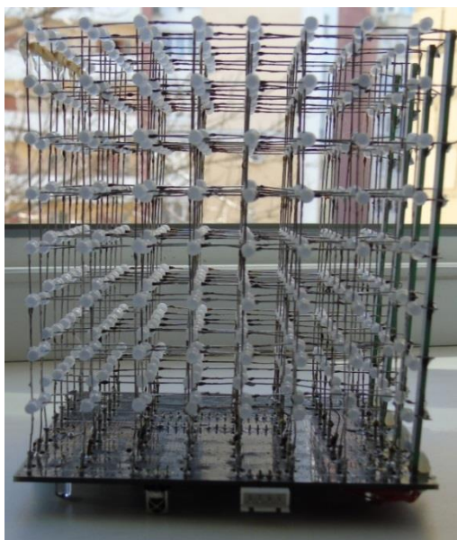
Рисунок 2.22 – готовый светодиодный 3D куб
