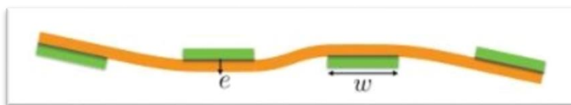
Рисунок 2.2 – Распределение сил для одной палочки
