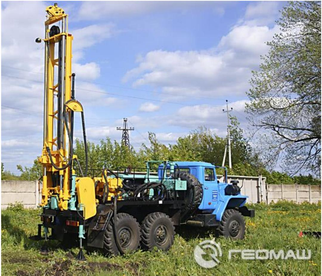
Рисунок 3.3 – Буровая установка ПБУ-2
