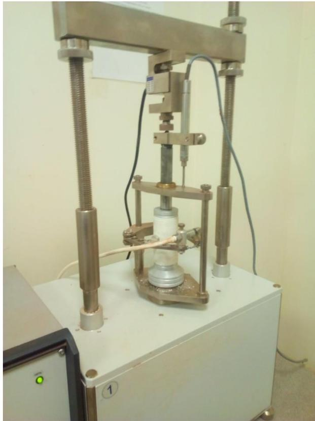
Рис. 2.2 – Установка одноосного сжатия
