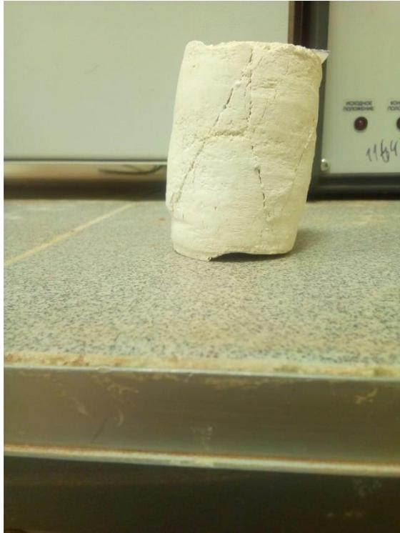
Рисунок 2.6 – Разрушенный образец мела
