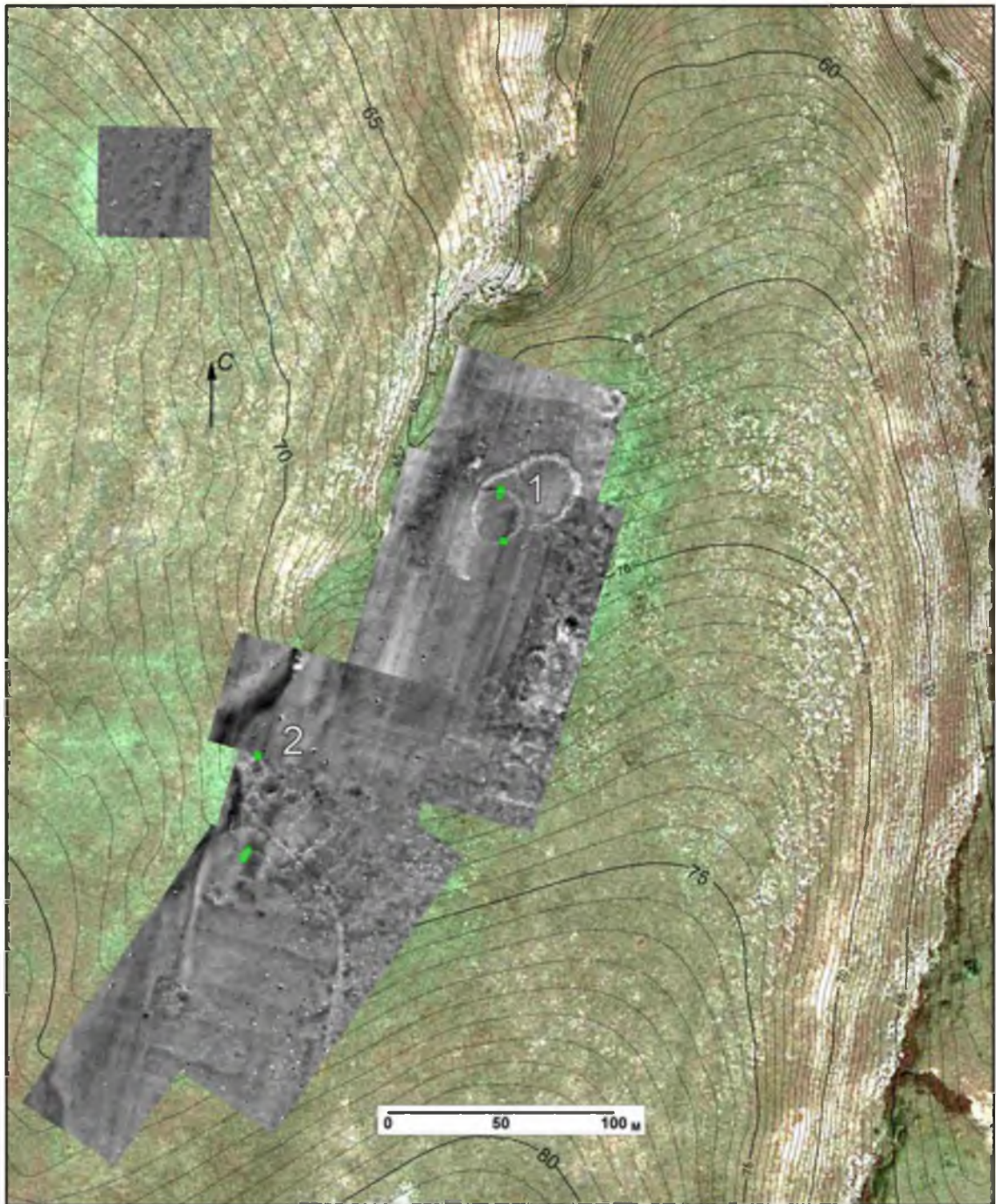
Рис. 1. Поселение Тарханкут Н-8 (см. №4 на рис. 2). Магнитная карта, помещенная на топографический план и космический снимок от 22 апреля 2009 г. Светлым тоном отмечены отрицательные, тёмным — положительные магнитные аномалии. 1 — двойной каменный загон; 2 — жилая и хозяйственная застройка поселения. Небольшими прямоугольниками отмечены шурфы, заложенные на поселении.
