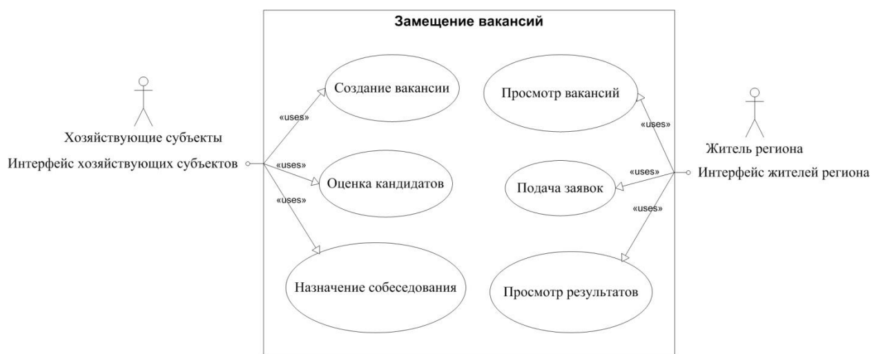
Рисунок 45 – Детализация варианта использования «Замещение вакансий»
