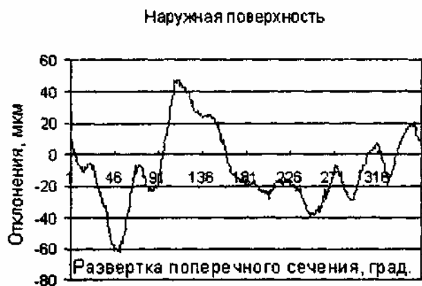
Рис. 1. Профиль поперечного сечения наружной поверхности трубы из сплава циркония.
