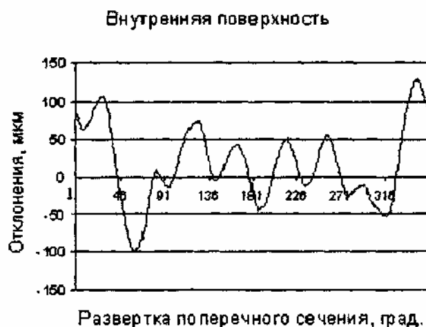
Рис. 2. Профиль поперечного сечения внутренней поверхности трубы из циркониевого сплава.
