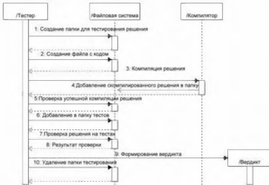
Рис. 1. Диаграмма последовательности для механизма тестирования решения пользователя
