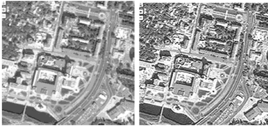
Рис. 2. Масштабированное изображение (слева) и изображение после градиентной обработки (справа)
