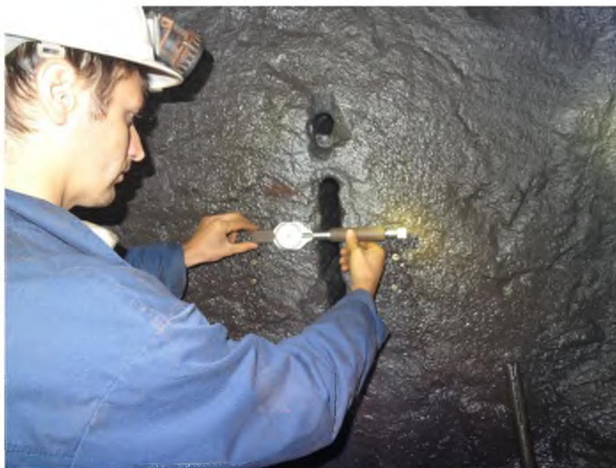
Рис. 3. Измерение горизонтальных деформаций механическим тензOMETром после разгрузки массива
