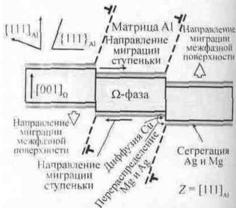
Рисунок 6. Схема процесса роста пластин \Omega -фазы во время деформации при повышенной температуре [8]
