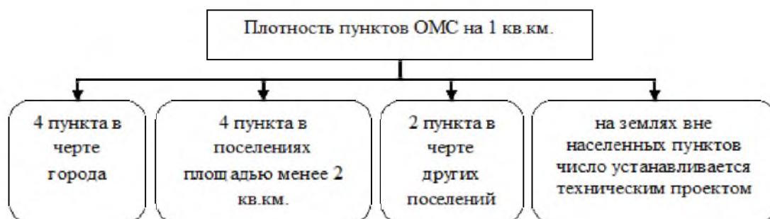
Рис. 2. Требования к плотности ОМС [Федеральная служба земельного кадастра России, 2002] Fig. 2. Requirements for density reference surveying networks [Federal Service of the Land Cadastre of Russia, 2002]
