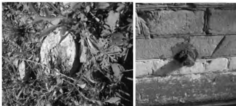
Рис. 4. Сохранившиеся пункты геодезической сети Fig. 4. The remaining points of the geodetic network
