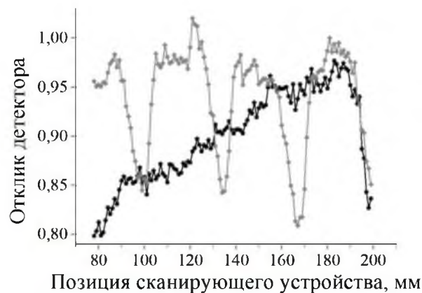
Рис. 7. Сравнение экспериментальных данных, полученных: —◆— с помощью цилиндра Фарадея, —●— непосредственно со сканирующего устройства
