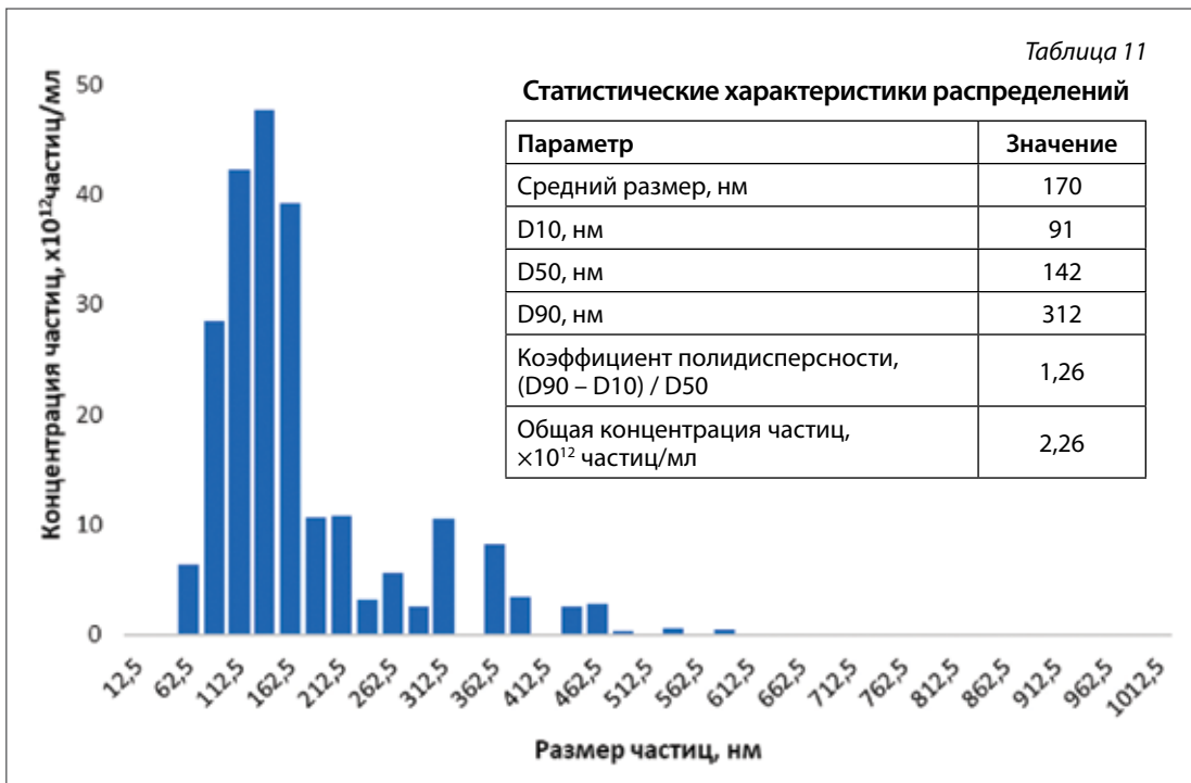
Рис. 12. Распределение частиц по размерам в образце нанокapsул сухого экстракта алоэ в агар-агаре (соотношение «ядро : оболочка» 1:2)
