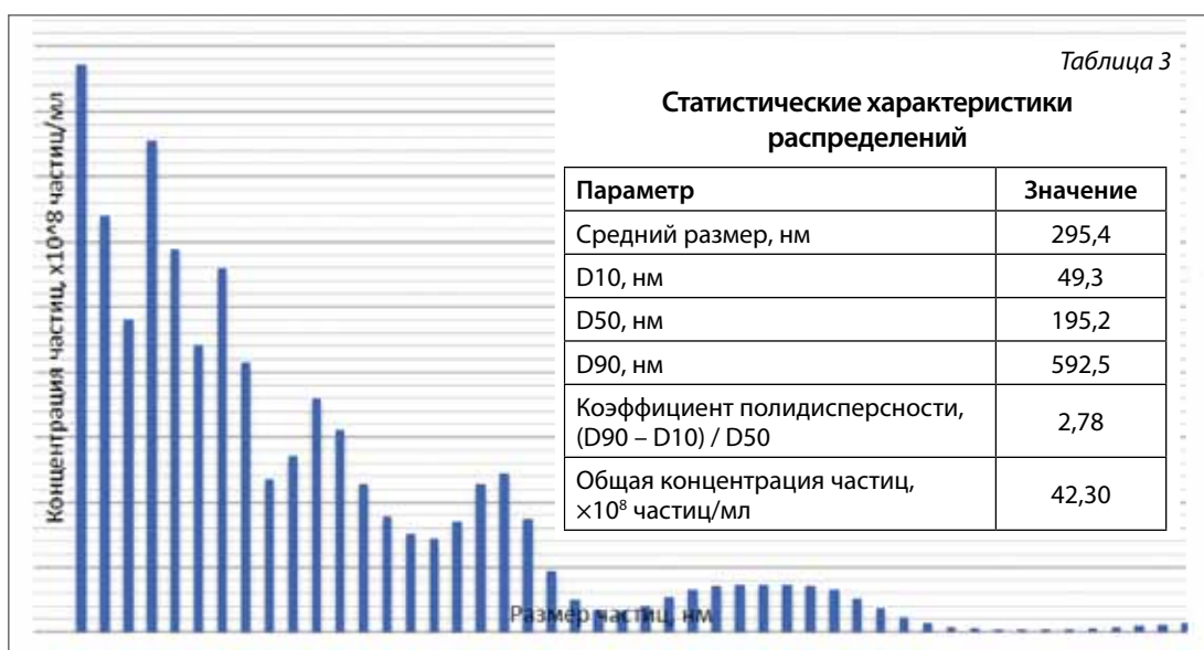
Рис. 4. Распределение частиц по размерам в образце нанокapsул сухого экстракта алоэ в гуаровой камеди (соотношение «ядро : оболочка» 1:3)
