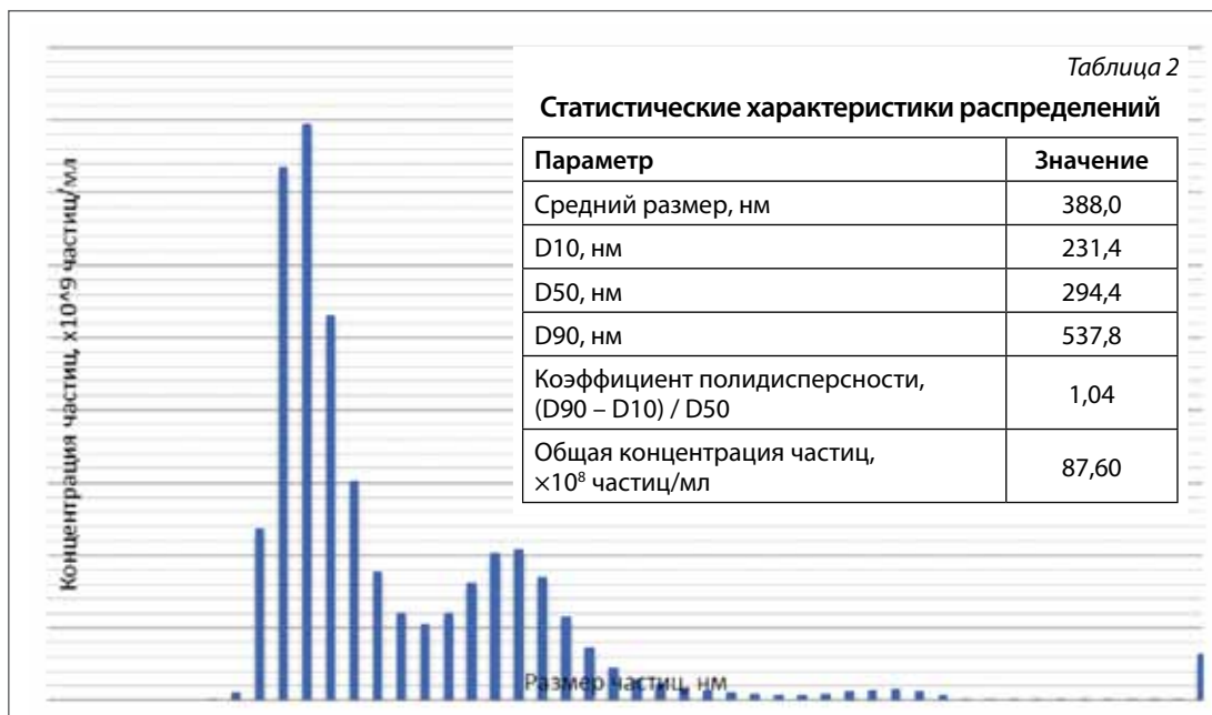
Рис. 3. Распределение частиц по размерам в образце нанокapsул сухого экстракта алоэ в гуаровой камеди (соотношение «ядро : оболочка» 1:2)
