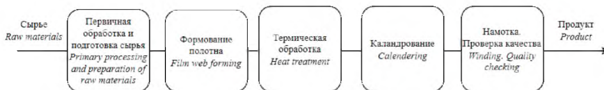
Рис. 2. Упрощенная схема процесса производства ТКМ
